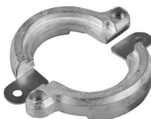
REFERENCIA 0521305/1 Collar Yanmar Saildrive SD20, SD25, SD30, SD31, SD40, SD50 y SD60. Peso: 0,65 Kg. Diámetro: 123 mm.
